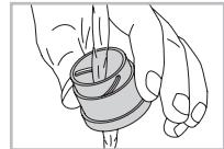
Bei starker Verschmutzung (z. B. Sand) ist die Drehaugenmuschel komplett abschraubar und somit einfachst zu reinigen.
