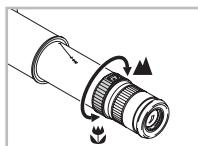
La regolazione della nitidezza viene effettuata girando l'anello di regolazione, che fa girare anche il tubo estraibile e l'oculare.
