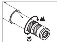
La mise au point s'effectue avec la bague de focalisation (l'oculaire tourne donc en même temps).
