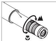
Terävyttä säädetään säätörengasta pyörittämällä, jolloin okulaariputki liikkuu suuntaan tai toiseen.
