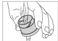
Si existe mucha suciedad (por ejemplo, arena), las copas del ocular se pueden desenroscar por completo para facilitar la limpieza.
