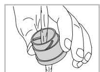
Per la pulizia del corpo del cannocchiale l'ideale è servirsi di un panno morbido ed umido (non usare il panno detergente per l'ottica). La sezione estraibile non va lubrificata.
