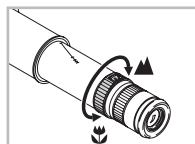
Skarpheden indstilles ved at dreje på indstillingsringen, hvorved trækrøret og okularet også bevæges.
