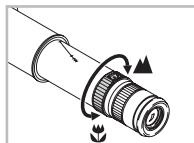
Die Scharfstellung erfolgt durch Drehen des Stellringes, wobei sich Zugrohr und Okular mitbewegen.
