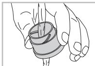
Bij sterke verontreiniging (bijv. zand) kan de draaidop er compleet afgeschroefd en dus heel eenvoudig gereinigd worden.
