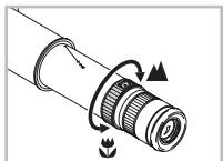
De scherpstelling vindt plaats door draaien van de stelring, waarbij de uittrekbare buis en het oculair mee bewegen.
