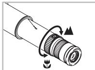
Фокусировка изображения выполняется путем поворота фокусировочного кольца при одновременном перемещении внутренней трубы и окуляра. На внутренней трубе имеется шкала расстояний.
